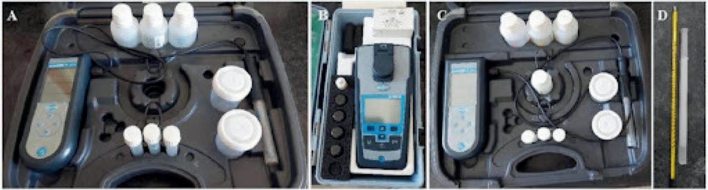
Fig. 3. Différents types de capteurs portables pour tester les paramètres physicochimiques de l'aquaculture. (A) Conductimètre/TDS, (B) Turbidimètre néphélométrique numérique, (C) pH-mètre et (D) Thermomètre scientifique
